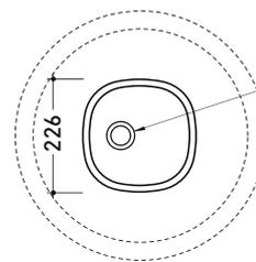
allaccio scarico tramite raccordo tecnico per lavabo in PP 40/50 mm con morsetto
