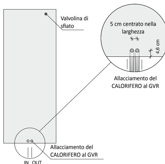
Il modello SQUARE è collegato all'impianto di riscaldamento mediante collegamento remoto GVR (Gruppo Valvole Remoto) fornito come accessorio.
